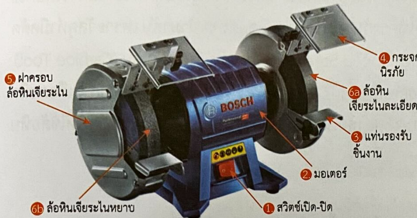
รูปที่ 3.3 ส่วนประกอบของเครื่องเจียรในแบบตั้งโต๊ะ
