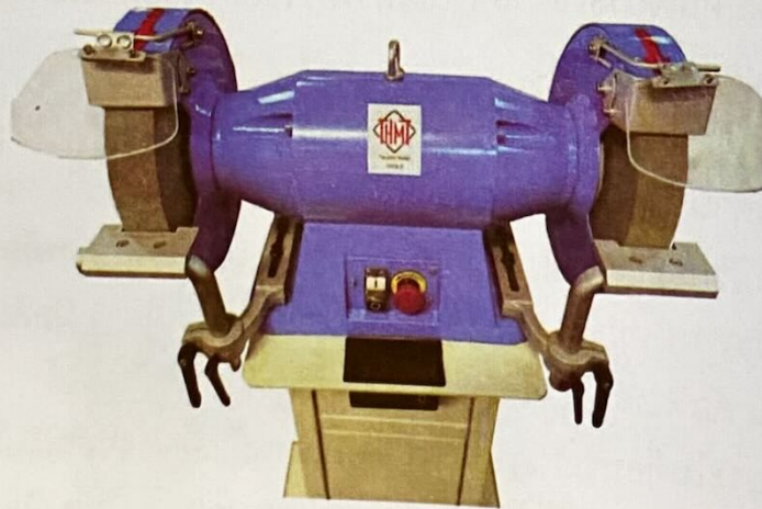
รูปที่ 3.37 ตรวจสอบความพร้อมของเครื่องเจียระไน กระบอกนิรภัย การ์ดป้องกัน แผ่นรองรับชิ้นงาน สวิตช์
